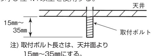
注) 取付ボルト長さは、天井面より 15mm~35mm にする。
